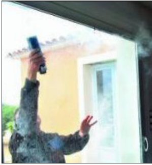
Dans une maison classique, l'air s'infiltrait partout : prises, gaines électriques, encadrements de menuiseries... Un véritable « gruyère ». (Photo F. C.-T.)
