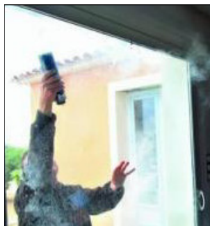
Dans une maison classique, l'air s'infiltrait partout : prises, gaines électriques, encadrements de menuiseries... Un véritable « gruyère ». (Photo F. C.-T.)
